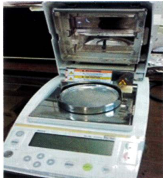
図1 ハロゲンランプ型水分計
