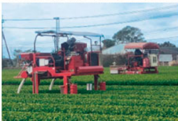
写真2 ロボット協調2台作業 (手前:ロボット施肥機,奥:従来機)
